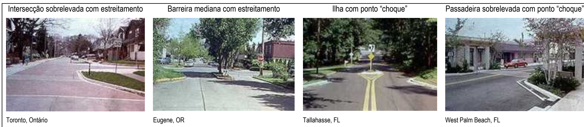
Figura 3.3 Exemplos de conjugação de soluções de “traffic calming”
