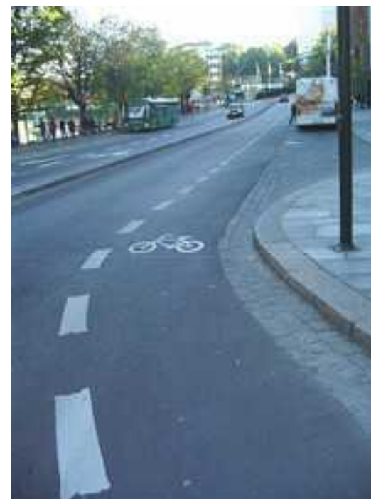
Figura 5.13 Faixa de bicicletas na proximidade de uma paragem de autocarros Stavanger, Noruega
